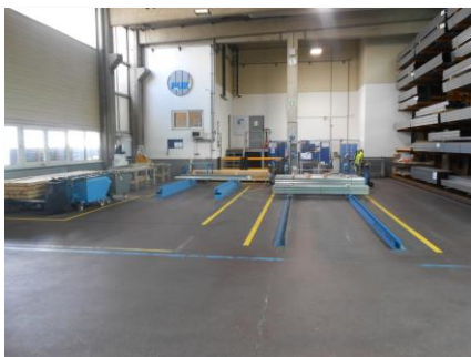
Rinnenverpackung nachdem 5S-Methode angewendet wurde, mit neuer erhöhter und ergonomischer Verpackungslinie (Foto: ifaa)
