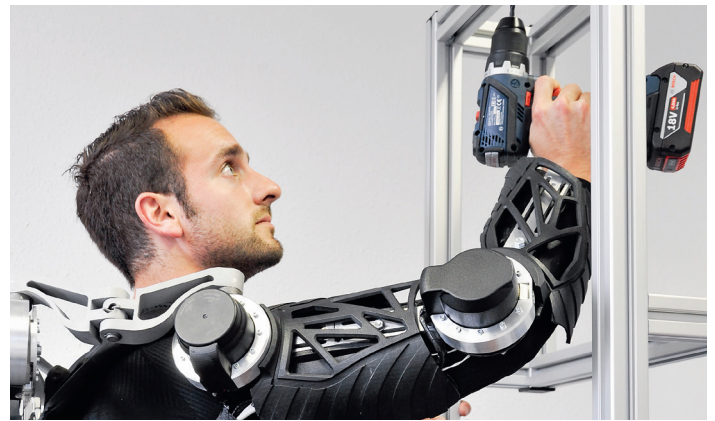
Abb. 1: Exoskelette entlasten Mitarbeiter zum Beispiel bei Über-Kopf-Arbeiten. Foto: © Fraunhofer IPA/Foto: Ludmilla Parsyak
