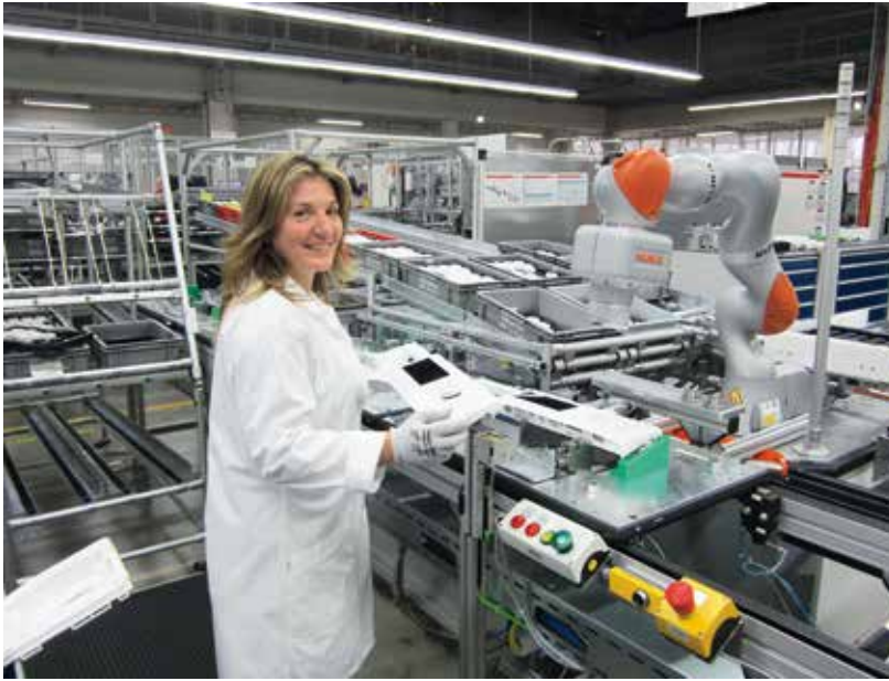
Abb. 2: MRK-Anwendung in der Montage von Bedienblenden für Waschautomaten im Miele-Werk Gütersloh.
