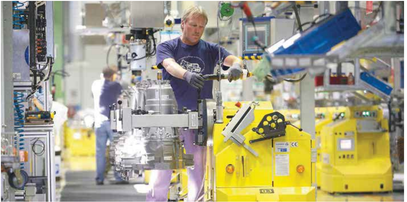
Abb. 2: Am ZF-Standort Saarbrücken werden 8-Gang-Automatgetriebe für Pkw gefertigt.
