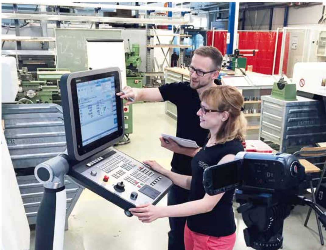
Abb. 3: Usability-Test an der CNC Universal-Drehmaschine
